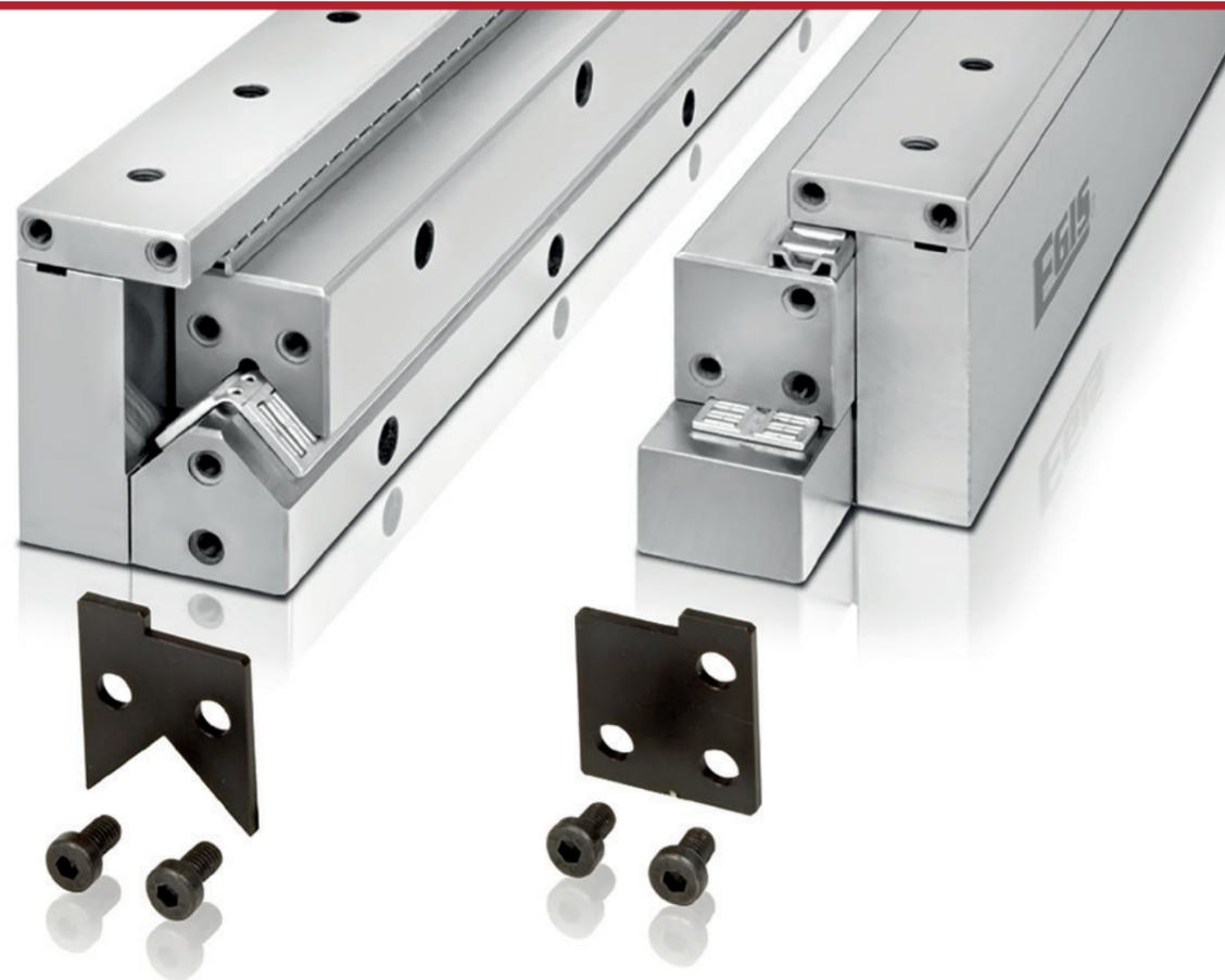
Le système de guidage LUE est spécialement conseillé pour une précision d'utilisation très élevée. Ce système est le plus précis de tous les guidages linéaires à roulements. Il est la solution parfaite pour les plus hautes exigences quant à la précision et la rigidité, tout particulièrement lorsque la charge principale est appliquée verticalement ou transversalement. La séparation en palier fixe et palier libre évite le gauchissement par dilatation thermique.
